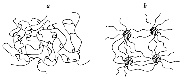
Рис. 18. Схема топологической структуры полидиметилсилоксановых сеток, сшитых короткоцепным сшивающим агентом.
